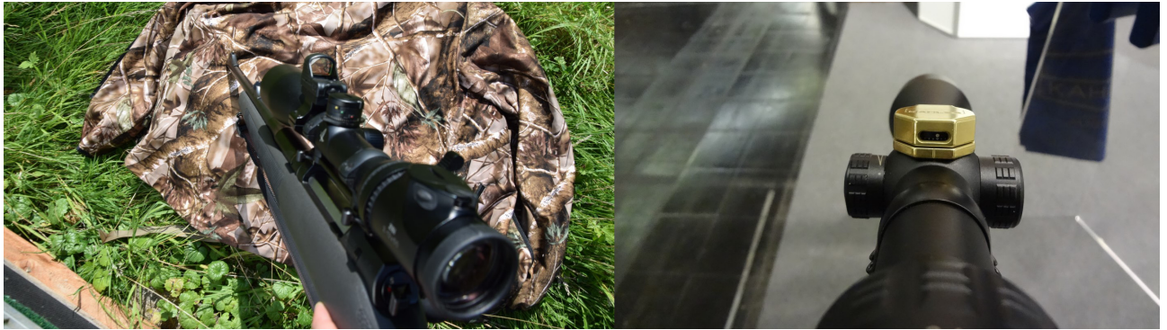
Abb. 9 Variationen von Absehensschnellverstellungen Auf dieser Abbildung sehen Sie links die Swarovski-Optik mit einem Verstellturm, der Einstellrasten hat. Auf der rechten Seite sehen Sie eine moderne Optik der Firma Kahles, mit einer Verdeckkappe über dem Verstellturm, die es zulässt, die Verstelleinheit zu sehen.
